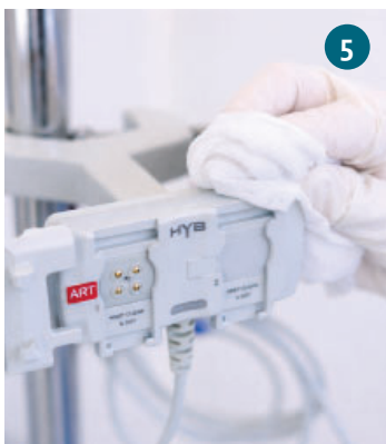
Kabel und Kontaktboard werden ausschließlich per Wischdesinfektion gereinigt.
