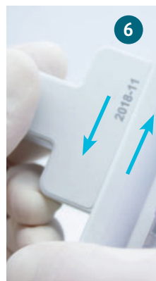
Durch entgegengesetztes schieben kann das Board vom AMTrans-Mount (AMTrans2900) bei Bedarf gelöst werden.
